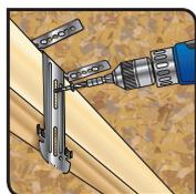
1. Appliquer les languettes en sous face de l'hourdis à l'aide de vis adaptées.
